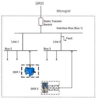
Fig. 2 : Sympathetic Tripping
